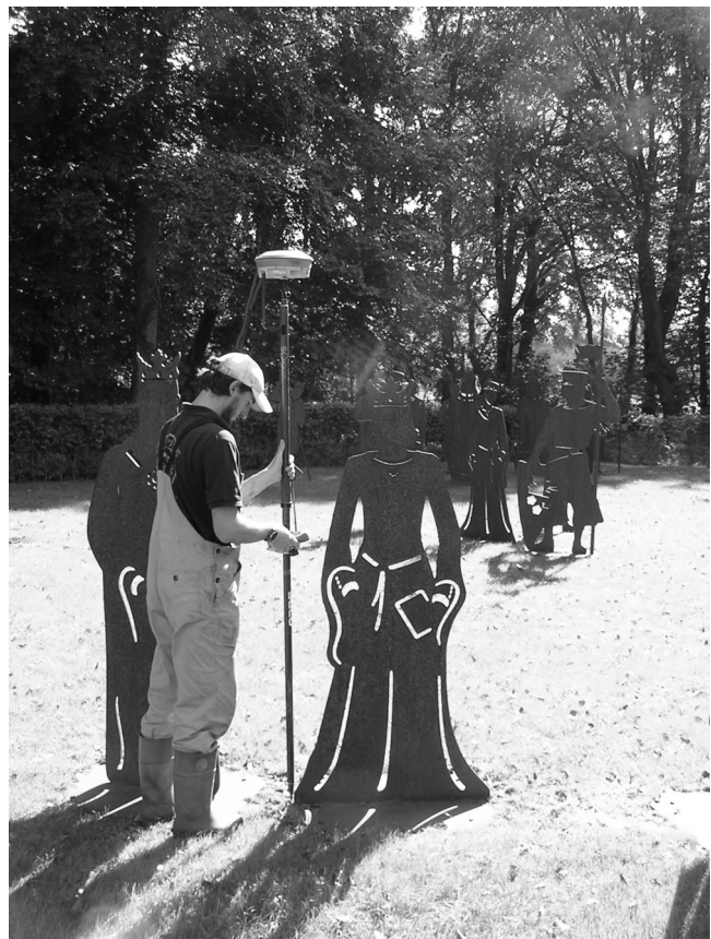
Het inmeten van het terrein, hier bij de beelden van Middeleeuws Weleveld, met een g.p.s. ten behoeve van een nauwkeurige kaart, waarop later de computer de weerstandsgegevens kan laten zien.
