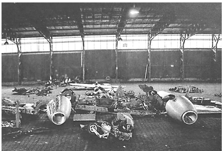
De brokstukken van het vliegtuig werden verzameld en in een hangar op de vliegbasis Twente op hun plaats gerangschikt. Zo heeft men kunnen achterhalen hoe het vliegtuig uit elkaar is gevallen.
