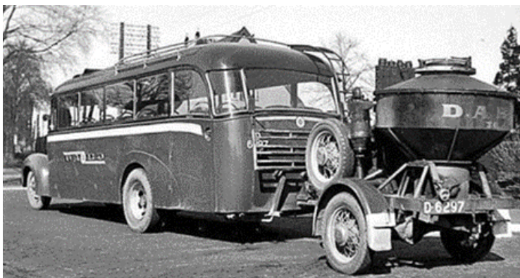
Een autobus uitgerust met een aangekoppelde hout-gasgenerator. Met een gelijksoortige autobus reisde Gerard Wensink in de oorlogstijd dagelijks van Hengelo naar Nordhorn.
