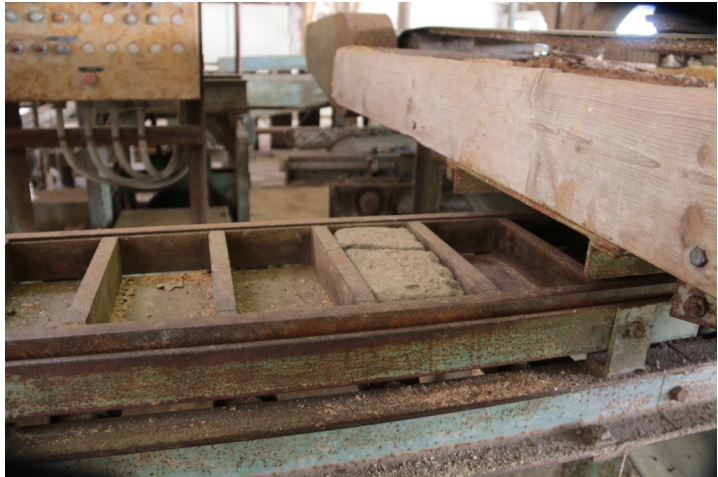
Het vormen van de stenen.
