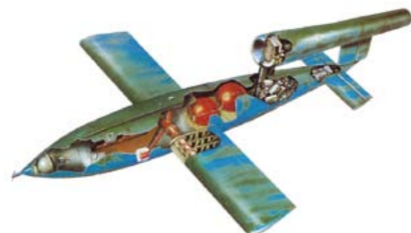
Plaatje 115. Technische tekening van een V1, een vliegende bom van de Duitsers.
